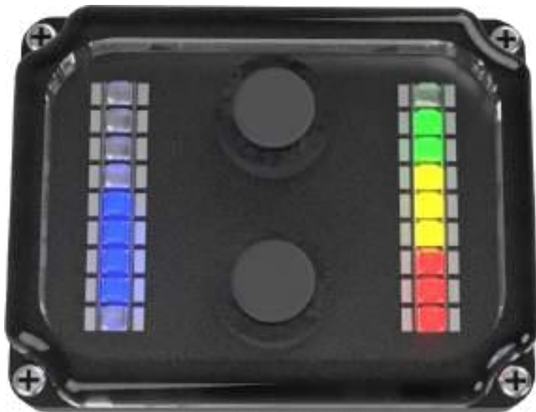
Zapnutý skútr, zařazený rychlostní stupeň 4
